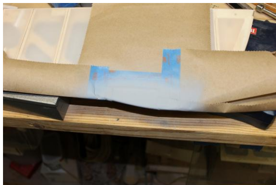
Using primer to define rudder trim tab
