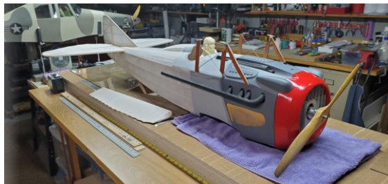
Flat gray primer on sheeting.
