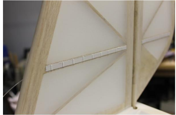
Faux rib stitch on vertical fin
